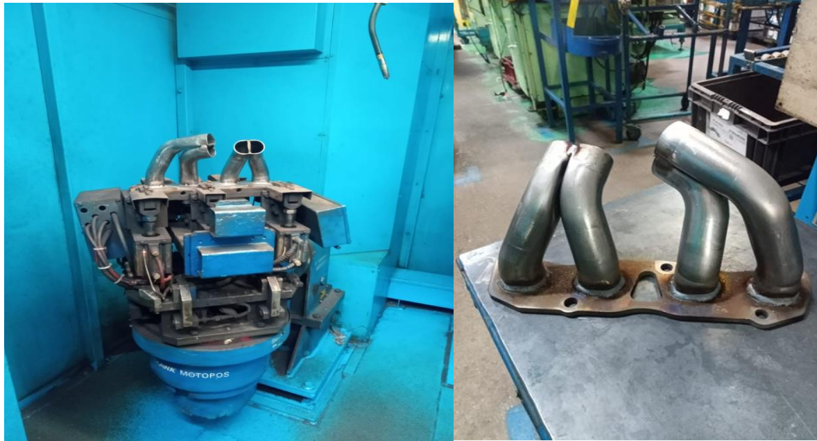
Figura 15. Imágenes referentes a la cabina #1 (lado A) de soldadura.
